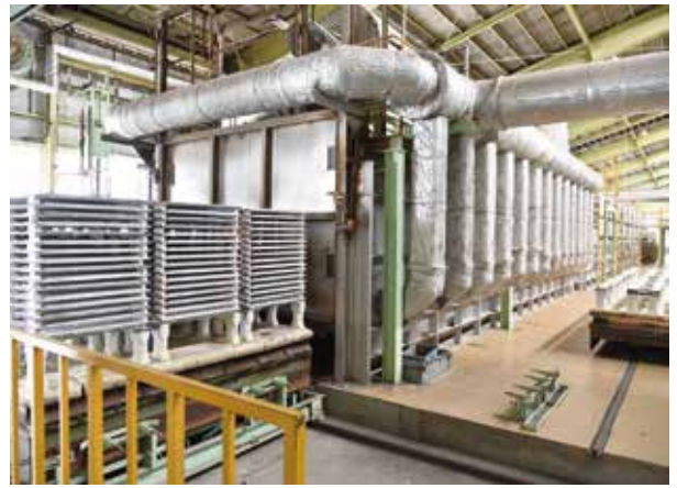
トンネルキルン(内熱式:ガス炉:100m)
