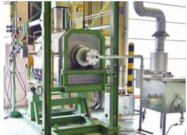
バッチ式ロータリーキルン(外熱式:ガス炉)
