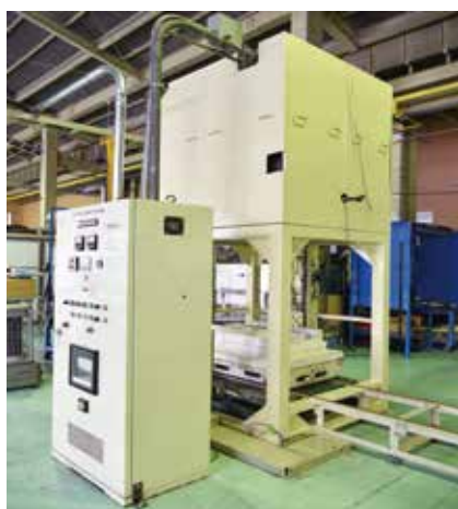
バッチ式電気炉(炉床昇降式:カンタルスーパー)
