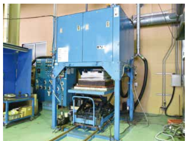
バッチ式電気炉(炉床昇降式:雰囲気炉)
