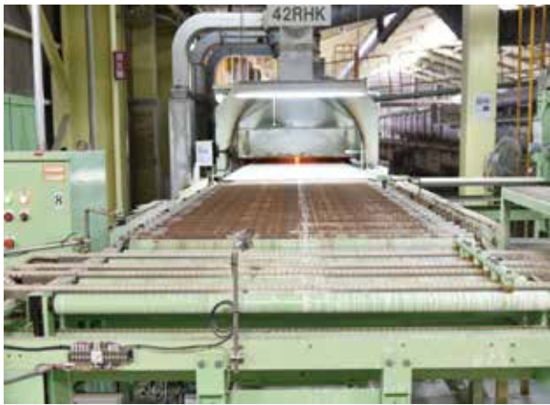
ローラーハースキルン(内熱式:ガス炉:80m)
