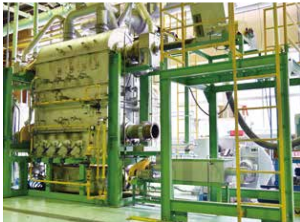
連続式ロータリーキルン(外熱式:ガス炉)
